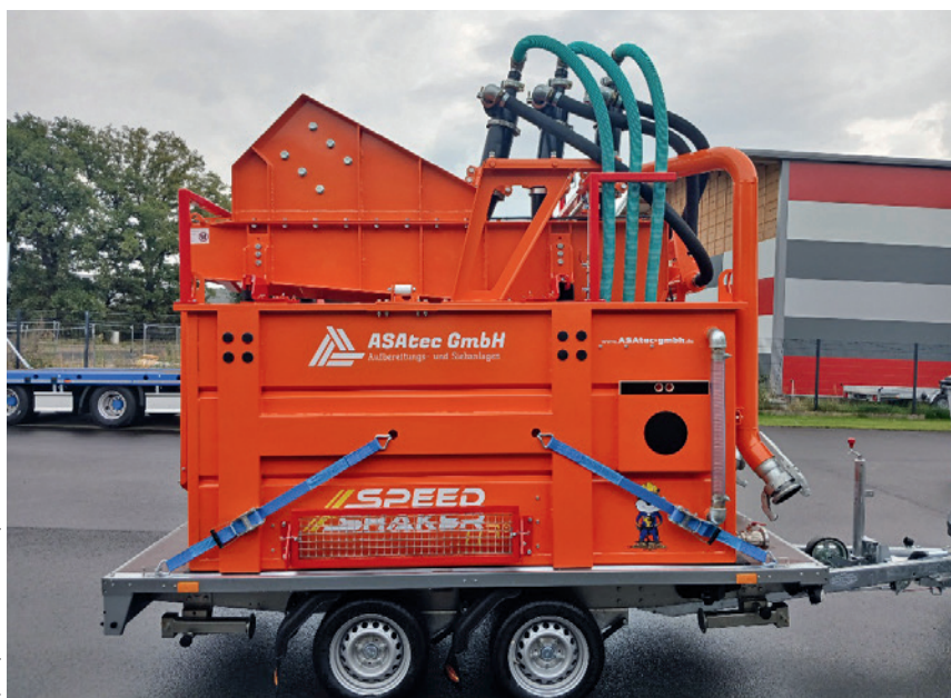
Anhänger und Siebanlage des SpeedShaker sind mobil und wiegen komplett nur ca. 2.700 kg.
